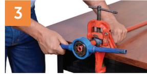
Para hacer la rosca usar tarraja con el dado para rosca "NPT" (cónica) correspondiente al diámetro del tubo. No usar la tarraja de polipropileno para roscar tubos de PVC y/o metálicos.
