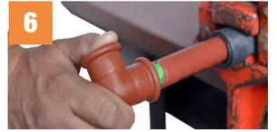
Efectuar el ajuste mediante presión manual del tubo con el accesorio.
