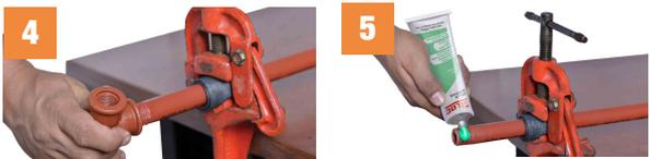
Prevea la limpieza de las roscas y compruebe en seco el roscado del tubo con el accesorio a instalar.
