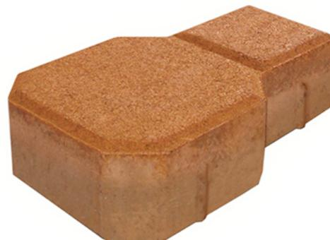
Adoquín de hormigón vibropresado. Bicapa, con la máxima saturación de color y mayor porcentaje de cemento en la capa superior garantizando la mejor resistencia a la abrasión y a la flexión.
