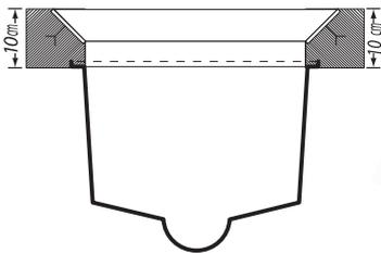
Para instalar la tapa de concreto, fundir base de hormigón de 10cm en el marco perimetral de la caja.
