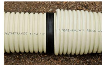
Se recomienda usar un bloque de madera y una barra para la instalación, asegurándose que el bloque proteja al tubo de la barra. Es necesario que en el proceso no se introduzcan partículas de material de relleno en la campana, para evitar fugas.
