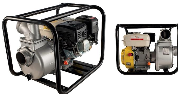
Herramienta de gran eficiencia y rendimiento, equipada con un potente motor de 7 caballos de fuerza, salida de 3". Capacidad para combustible (Gasolina) de 0.16 galones. Tiene una succión de 7 metros y elevación máxima de 28 metros, y un caudal máximo de 35 m<sup>3</sup>/h. Excelente equipo para solucionar problemas de inundaciones, traslado de agua, drenaje, entre otros. Compatible con manguera espiral, lona, galvanizada, polietileno o de PVC (3 pulgadas)
