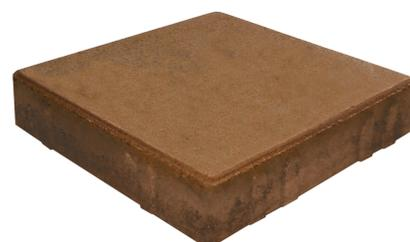
Adoquín de hormigón vibropresado. Bicapa, con la máxima saturación de color y mayor porcentaje de cemento en la capa superior garantizando la mejor resistencia a la abrasión y a la flexión.
