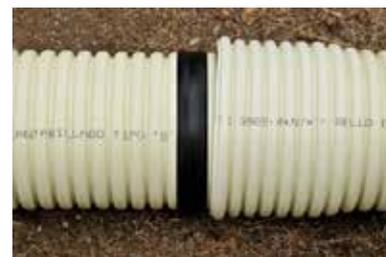
Se recomienda usar un bloque de madera y una barra para la instalación, asegurándose que el bloque proteja al tubo de la barra. Es necesario que en el proceso no se introduzcan partículas de material de relleno en la campana, para evitar fugas.
