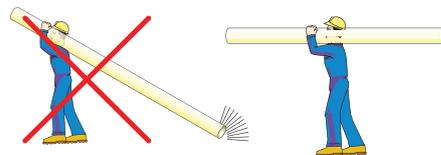
No los deje caer ni arrastre los tubos, ni los accesorios al piso para evitar el deterioro de los cauchos ubicados en sus extremos.
