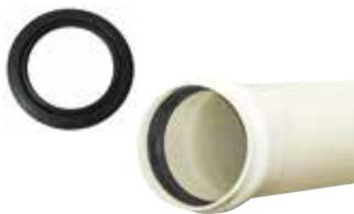
Las tuberías se fabrican con su campana y espigo; su respectivo hidrosello con alma de polipropileno instalado en fábrica, garantiza un adecuado ensamble en obra, evitando su desplazamiento en el proceso de instalación.
