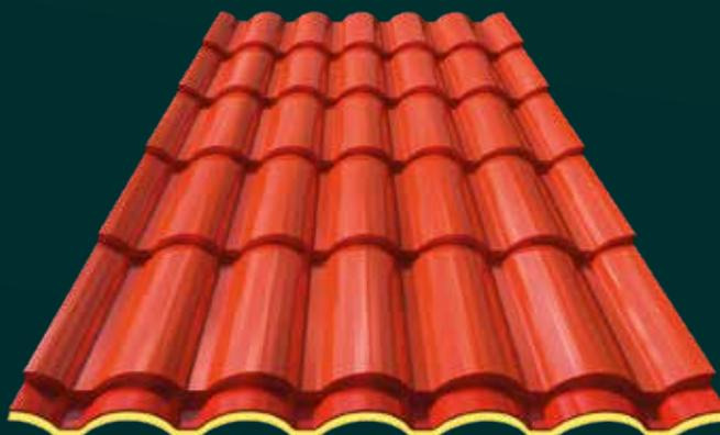
La Kubiteja Residencial termoacústica, conformada por una capa superior de acero galvalume o prepintado y aislamiento de poliuretano rociado de espesores de 5mm.
