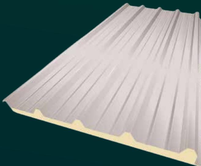
El panel Kutermico se fabrica para cubiertas y paredes. El panel metálico tipo sandwich, fabricado en línea continua, está conformado por una lámina superior y una lámina inferior, que puede ser de: acero gavalume, inoxidable, galvanizado o aluminio; aislados con: espuma rígida de Poliisocianurato (PIR) Poliestireno Expandido (EPS), o Corta fuego (Lana Mineral de Roca).
